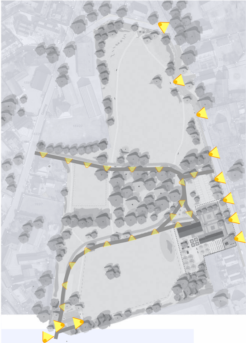
Bodeneinbauleuchte Bega entlang Hauptwege
