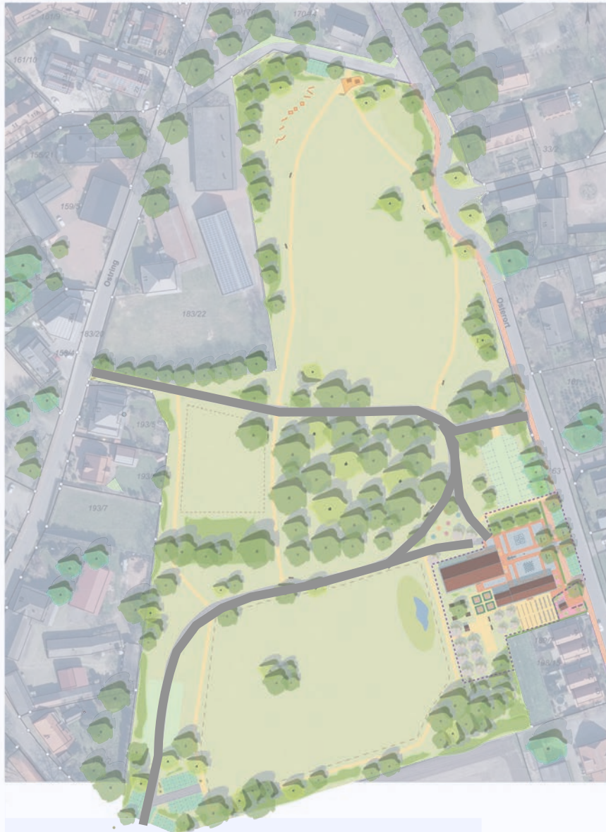
Schmaler Asphaltweg 2.50 breit, 60% Recyclingasphalt
